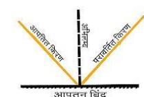
2. दूसरे नियम के अनुसार आपतन कोण , परावर्तन कोण के बराबर होता है , आपतन कोण को  $i$  से तथा परावर्तन कोण को  $r$  से सूचित किया जाता है ।
